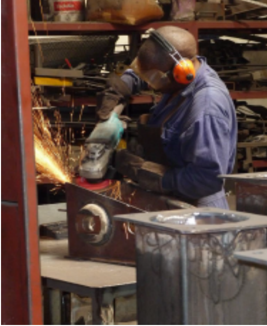
Figure 6.4 : Ce travailleur à Nairobi, au Kenya, porte trois types d'équipements de protection individuelle : gants, protection auditive à type de coquilles anti-bruit et protection des yeux à type de lunettes à coques. C'est ce qui devrait être fait. Le travail consistant en l'affûtage de pièces métalliques peut causer de graves blessures à la main, le bruit quand à lui peut entraîner une perte de l'audition et les débris de métal peuvent gravement endommager l'œil, ce qui fait que les trois types de protection sont nécessaires. (Crédit Photo avec la permission de Suvi Lehtinen, Institut Finlandais de la santé au travail).
