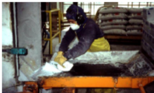
Schéma 5.3 : Cet ouvrier introduit l'amiante dans une chute où il ira dans une cuve à mélanger au ciment.
