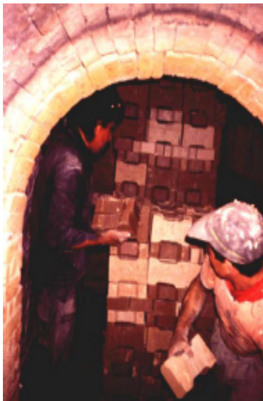
Figure 3.1 : Ces ouvriers empilent les briques non finies à l'intérieur d'un four pour la mise à feu. Voyez à quel point il est difficile de porter les briques une par une. Les ouvriers utilisent un chariot sur des roues pour apporter les briques au secteur de four mais le chariot est trop grand pour venir plus près.
